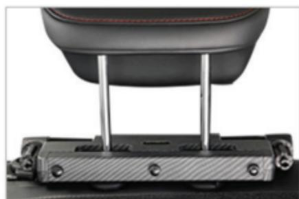
2. Nastavte posuvnú tyč do správnej polohy a nainštalujte ju na tyč opierky hlavy, zakryte zadný kryt a rukou utiahnite 3 skrutky
